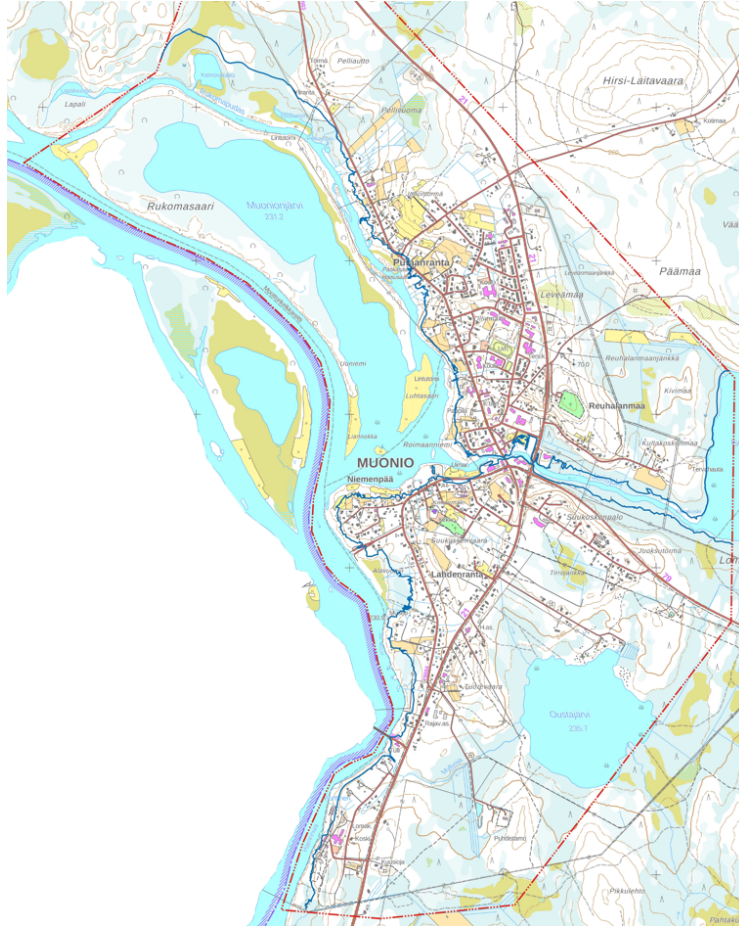
Kuva 28. Muonion vedenkorkeusaseman kerran 100 vuodessa toistuvaa tulvavedenkorkeutta vastaava korkeustaso perustuen 2x2 m korkeusmalliin.
